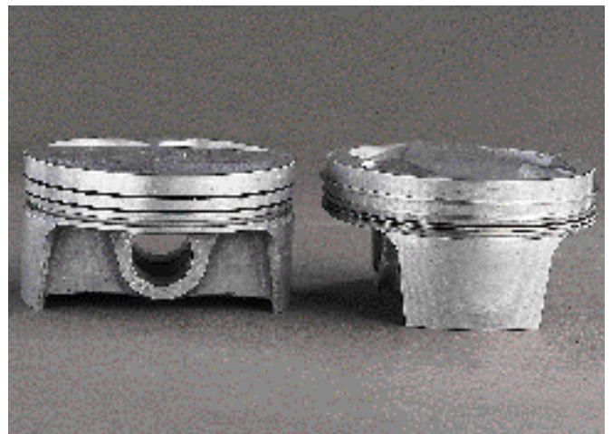
L'altezza del mantello è molto ridotta, con il foro dello spinotto il più vicino possibile alla zona dei segmenti per ottenere la migliore bilanciatura insieme ad una notevole compattezza dello stantuffo.
