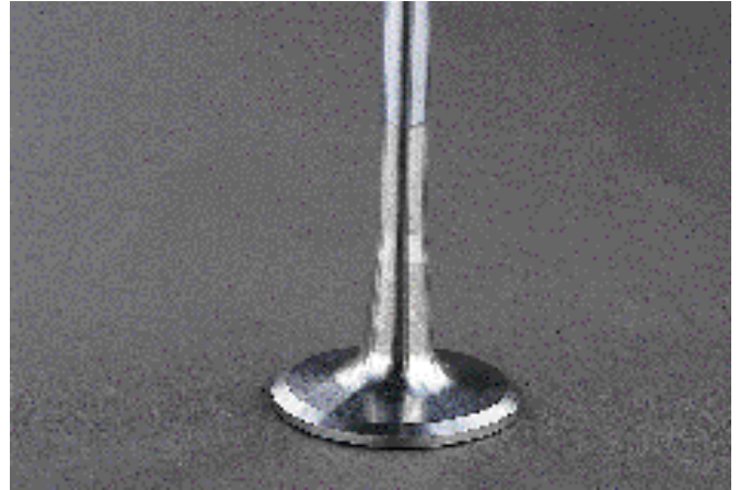
Dettaglio del fungo di una valvola, dove si nota il vistoso aumento del diametro del tratto dello stelo più prossimo al piattello. Con questo disegno si migliora il comportamento della valvola a fronte delle sue vibrazioni trasversali che, chiaramente, hanno luogo nella parte libera, più lontana dal tratto che scorre nella guida ed eccitata a vibrare dal martellamento contro la sede.
