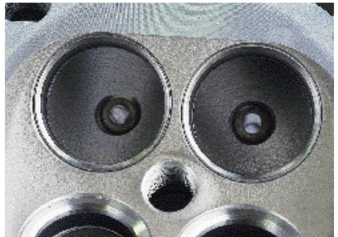
Le uscite dei condotti di aspirazione sono accuratamente realizzate e denotano un attento studio della fluidodinamica, sono caratterizzate da ampie aree di passaggio anche intorno alle valvole, che riducono l'effetto negativo causato dalla vicinanza di spigoli e pareti per ottimizzare l'efflusso.
